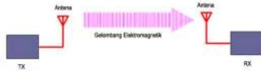
Gambar 2.2 Peran antenna di sistem komunikasi nirkabel , Antena terletak diujung sistem komunikasi yang menggunakan gelombang elektromagnetik/radio
