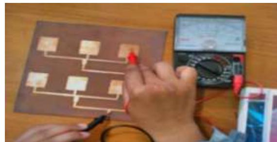
Gambar 4.1 Pengecekan arus listrik pada 6 elemen antena array mikrostrip menggunakan multimeter
