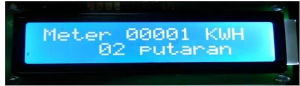
Gambar 13. Tampilan LCD Saat 2 Putaran maka KWH Meter 00001
