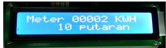
Gambar 14. Tampilan LCD Saat 10 Putaran maka KWH Meter Bertambah Menjadi 00002
