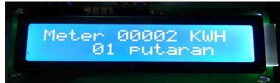
Gambar 15. Tampilan LCD Saat 1 Putaran maka KWH Meter Tetap Menjadi 00002
