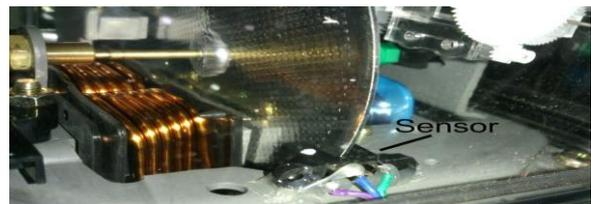
Gambar 8. Sensor Dipasangkan Pada Bagian Dikikir
