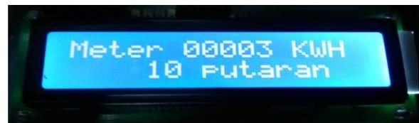
Gambar 16. Tampilan LCD Saat 10 Putaran maka KWH Meter Bertambah Menjadi 00003
