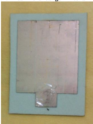
Gambar 4.27 Hasil Rancangan Antena Mikrostrip
