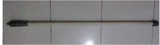
Gambar Antena Omni collinear dengan selubung pipa PVC
