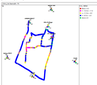
Gambar 3.4 Contoh Hasil Drive Test Berdasarkan EC/IO
