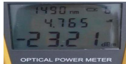
Gambar 4.2 Pengukuran Power Link Budget pada ONT 1 (*downstream*)
