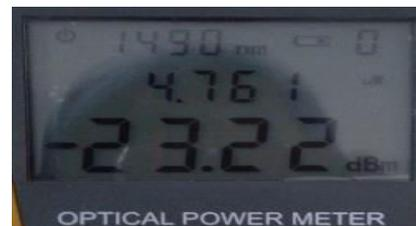
Gambar 4.3 Pengukuran Power Link Budget pada ONT 2 (*downstream*)
