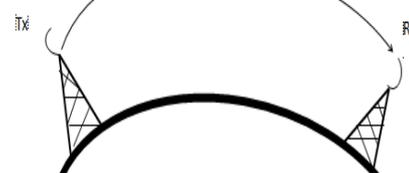
Gambar 2.1 Propagasi gelombang tanah
