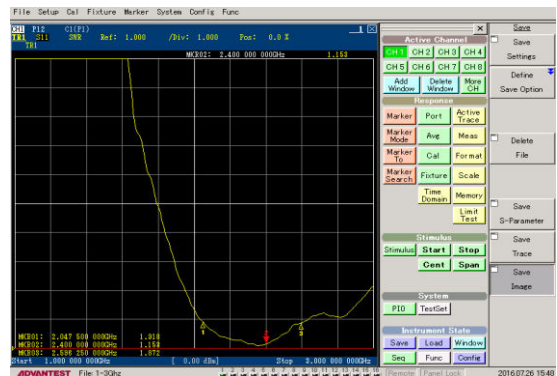
Gambar 4.2 Hasil Pengujian VSWR
