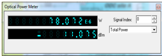
Gambar 4.4 Daya Terima pada jaringan feeder point to point ODC site A yang berjarak 3.529 Km
