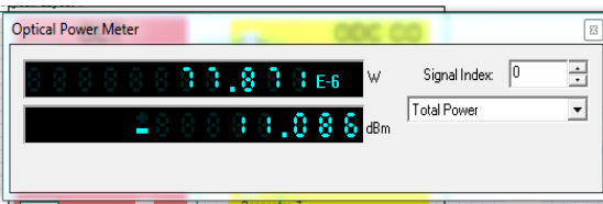
Gambar 4.5 Daya Terima pada jaringan feeder point to point ODC site B yang berjarak 3.561 Km
