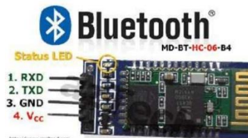
Gambar 2.4 Konfigurasi Pin Bluetooth HC-06
