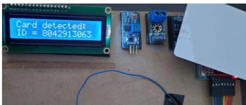
Gambar 4 Pengujian Tap Kartu RFID
