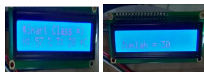
Gambar 8 Pengujian Pada Sensor DHT11
